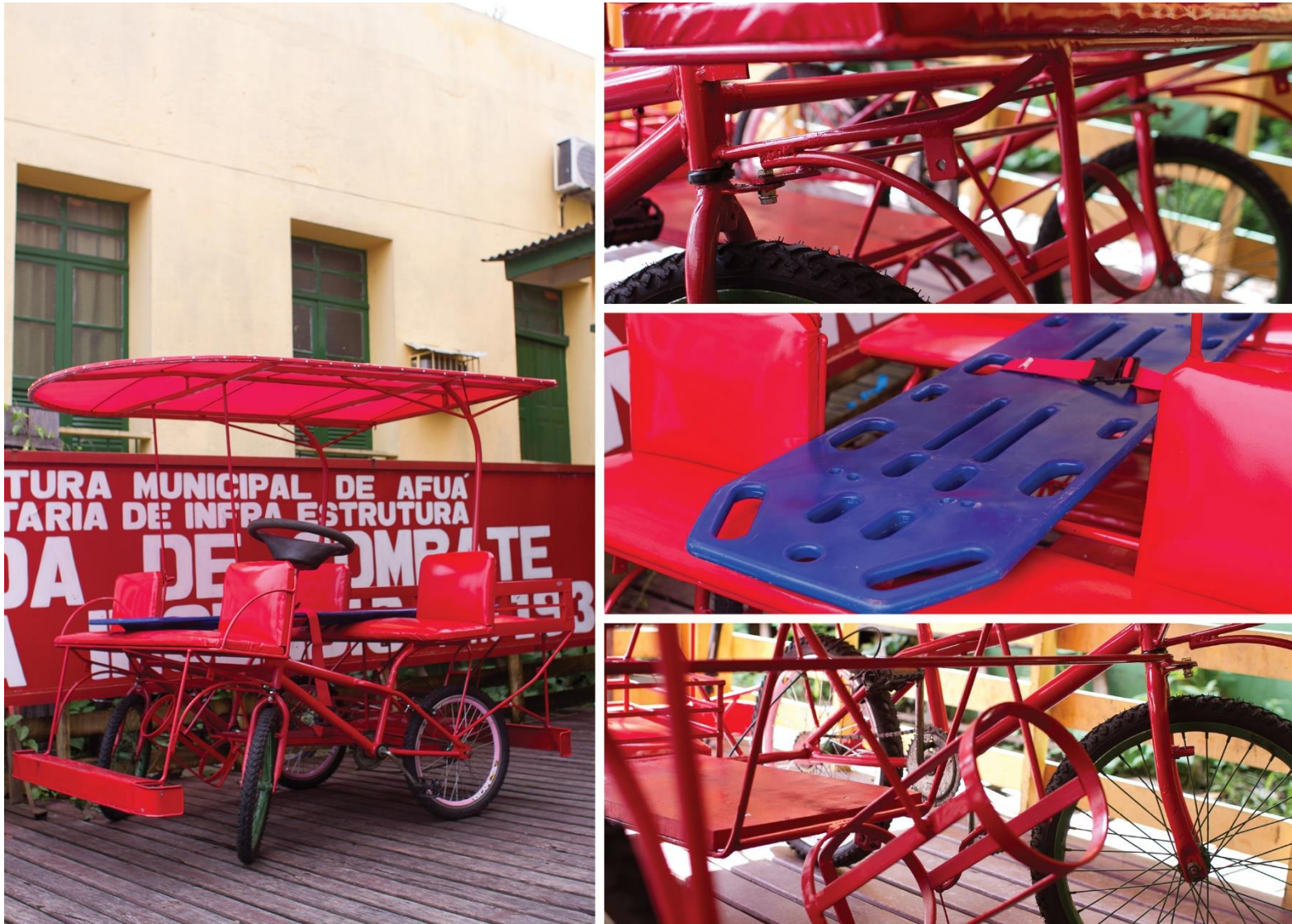
Fig. 80: Bicilância confeccionada para a brigada de incêndio. Fonte: Aislan de Paula, arquivo pessoal, 2014.
