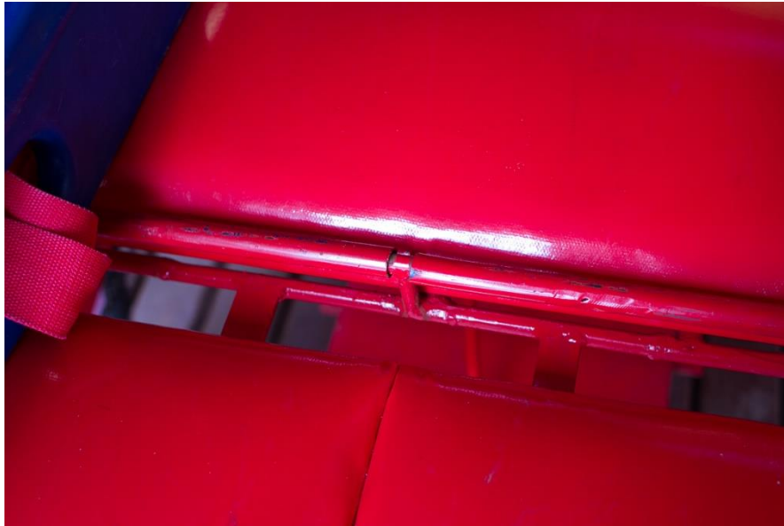
Fig. 81: Área crítica do veículo, onde se notam remendos na estrutura que sustenta os assentos e a maca.
