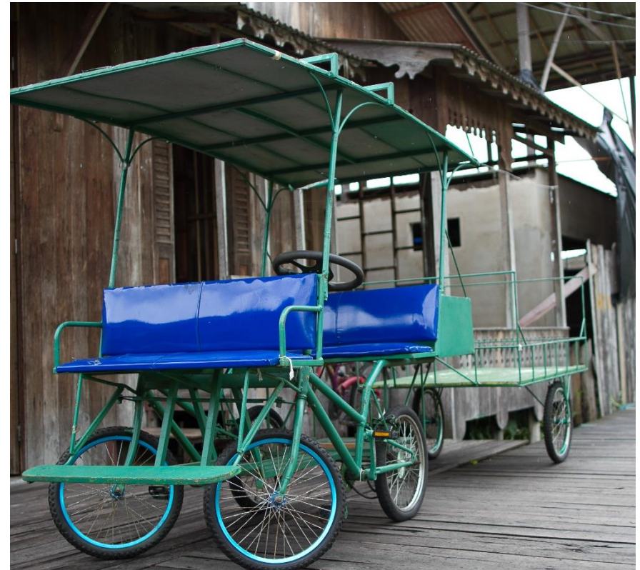
Fig. 54: Bicitaxi de quatro rodas criado por Sarito. Fonte: Aislan de Paula, arquivo pessoal, 2013.
