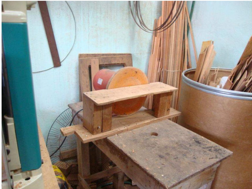
Figura 39 - Adaptação de uma lixadeira para fazer um detalhe específico de um produto, 2010. Fonte: Arquivo pessoal,
